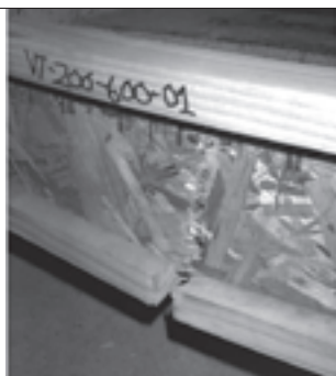
Foto 4 Falla por corte en el alma
