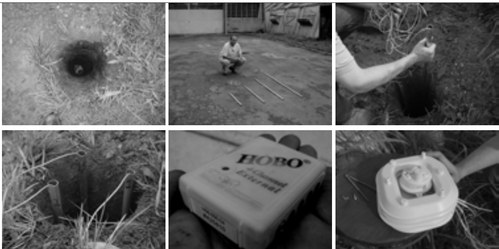
Foto 1 Colocación de sensores para el registro de la temperatura del subsuelo a 50, 100, 150 y 200 cm
