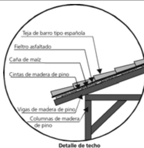
Foto 3 Detalle de la composición del techo de la casa de bajareque.
