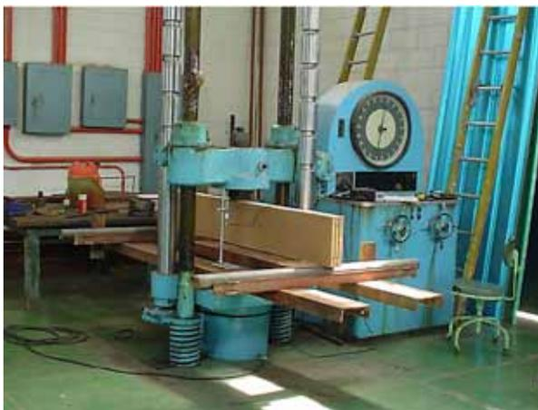
Probeta colocada con confinamiento
