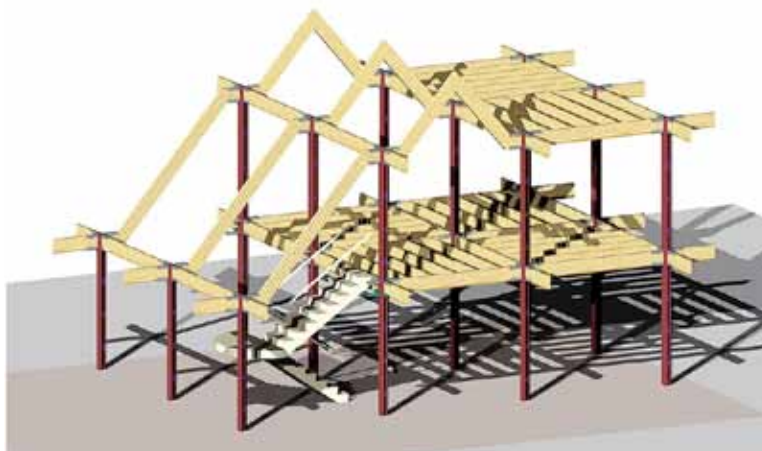
Figura 1. Sistema constructivo para viviendas, criterio utilizado para la ubicación de miembros estructurales de madera
