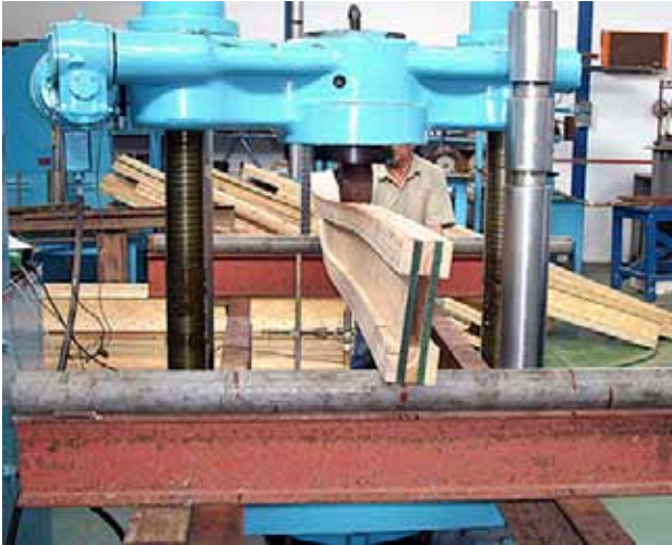
Fotos 14 y 15. Deformaciones laterales durante aplicación de carga
