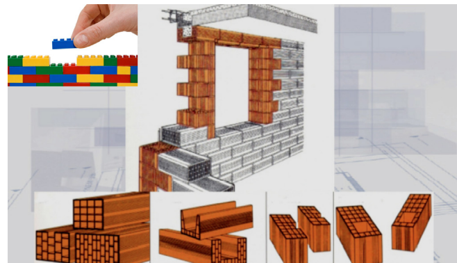
Gráfico 4. Coordinación dimensional entre diferentes tipos de bloques emulando la idea del Lego
