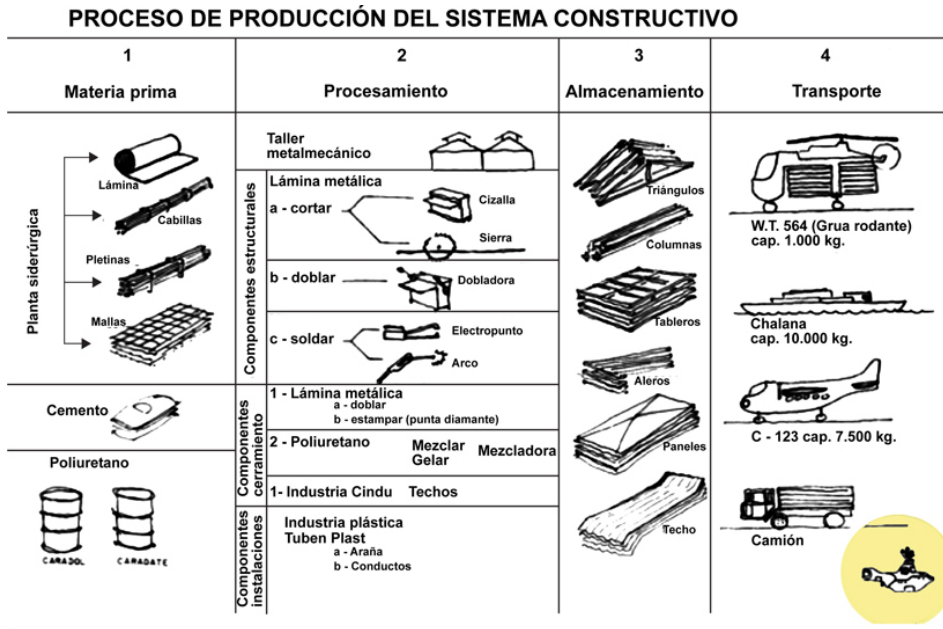
Gráfico 5 b. Sistema constructivo San Carlos de Rio Negro, Arq. Domingo Acosta, 1977
