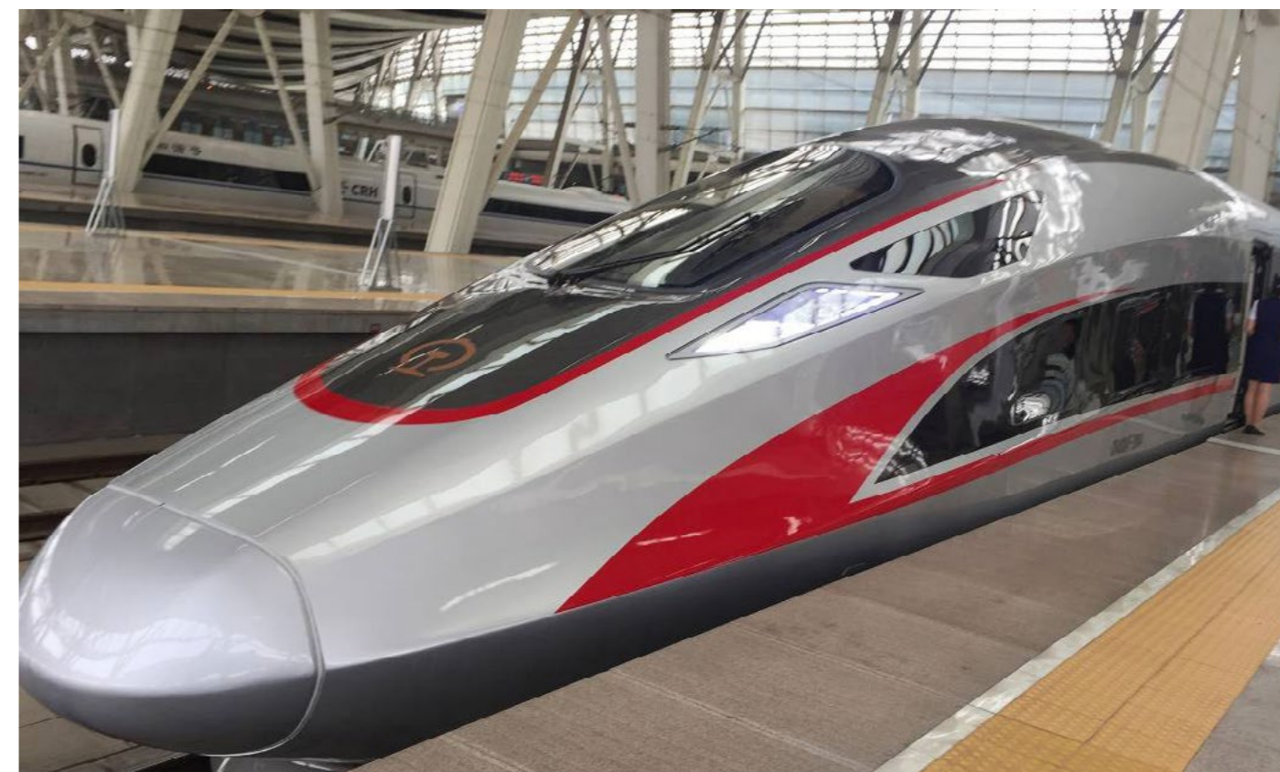
Figura 3. El tren bala de nueva generación 'Fuxing'. Debutó en el trayecto Beijing-Shanghai en 2017. Un tren Fuxing partió de Beijing y otro hizo lo propio de Shanghai, alcanzando una velocidad máxima en el recorrido de 400 km/h y manteniendo una media de 350 km/h.
