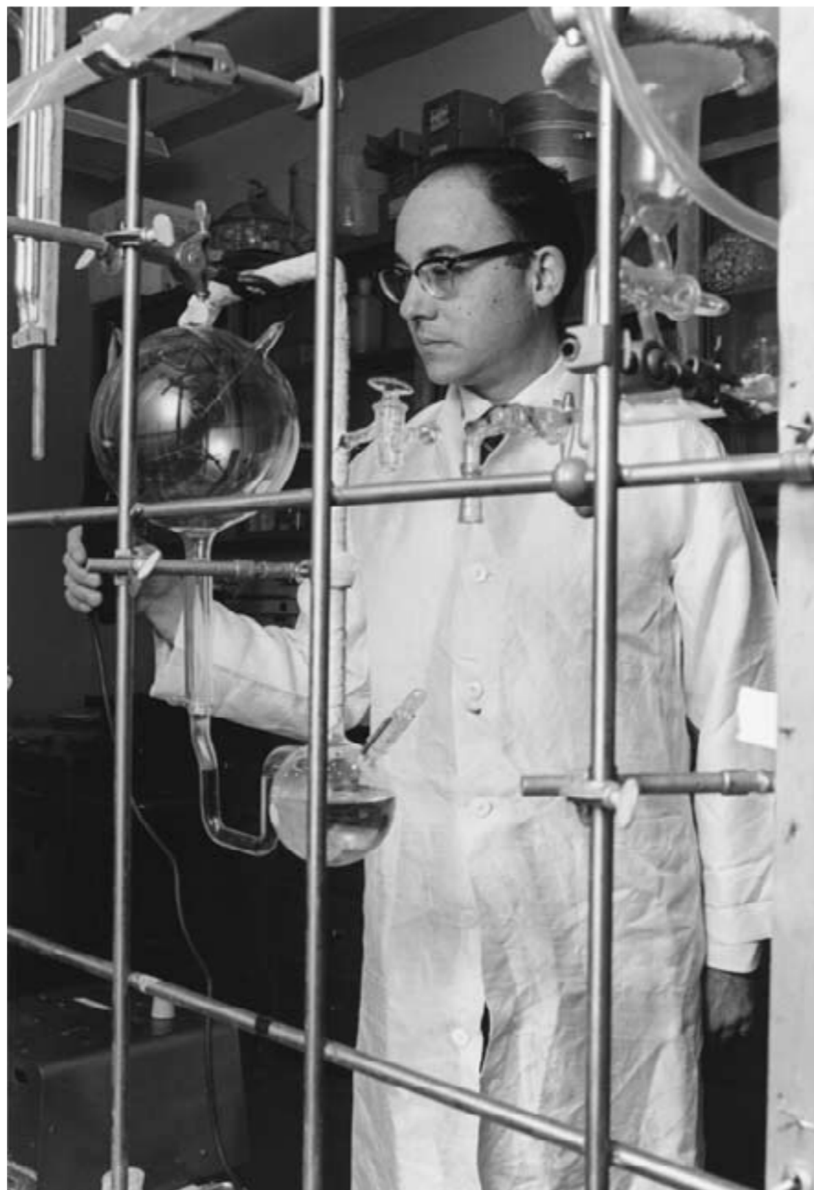
Figura 3: (Izquierda) El biólogo Stanley Miller frente a su diseño experimental para realizar sus famosos ensayos, 1953. (Derecha) El aparato se llena con una atmósfera de metano, amoníaco e hidrógeno. Un globo lleno de agua simula un océano primitivo (el agua es calentada por una resistencia, lo que contribuye a enriquecer la atmósfera de vapor de agua). Dos electrodos, que se utilizan para producir relámpagos, suministran energía al sistema. Después de una semana de funcionamiento, diversos compuestos orgánicos incluyendo aminoácidos precipitan en el fondo del matraz.
