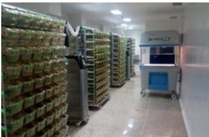
Figura 12 IZQ. Rack Ventilado. - DER. Cabina de Flujo Laminar CS5
