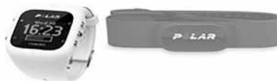
Figura 1. Instrumentación utilizada (reloj A300 monitoreo de frecuencia cardíaca - sistema polar banda h5 para el registro de la frecuencia cardíaca).
