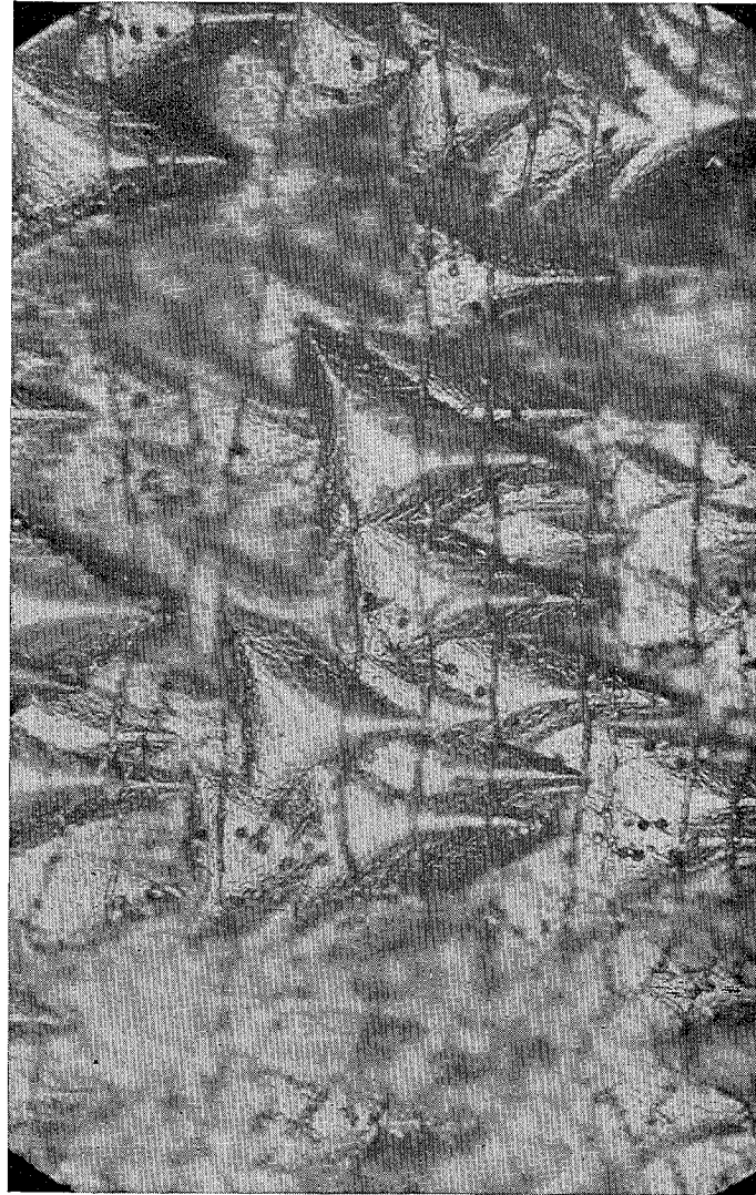
Fig. 13. 1500 X Relación entre dislocaciones decoradas y planos (111) en el metal.
