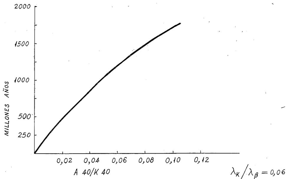
la edad geológica de la roca por la vida media del potasio y de la fracción que se desintegra por el proceso de captura K.
