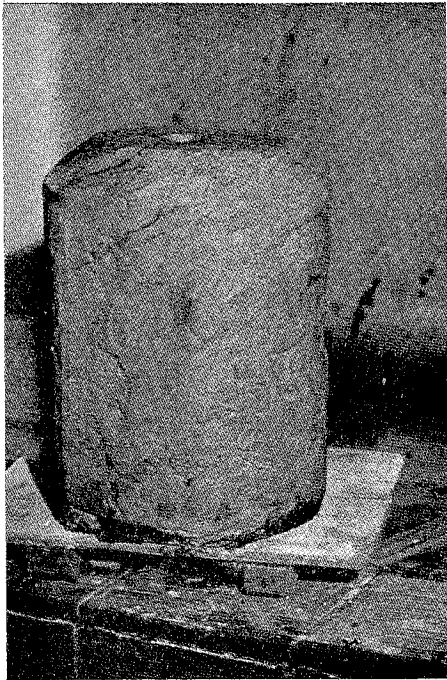
Fig. 8. Aspecto del molde después de fraguar la mezcla de yeso; el modelo de cera y macho han quedado en su interior. Posteriormente se llevará a un horno para eliminar la cera y formar la cavidad que recibirá el metal fundido
