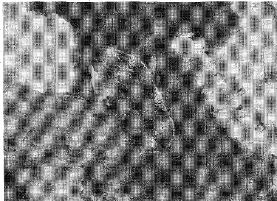
Fig. 6b Grano glauconítico alterándose a sílice (S) microcristalina, dando el aspecto de un grano de chert. Arenisca de la Formación Caratas en Río Querecual.
