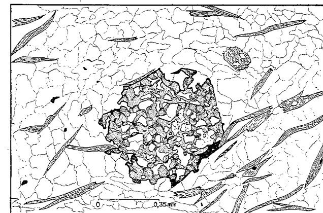
Fig. 19 Esquisto cuarzo muscovítico granatífero. Porfidoblasto de granate con numerosas inclusiones de cuarzo y textura esqueletal. La textura indica la cristalización post-tectónica del granate con respecto a S_2 .
