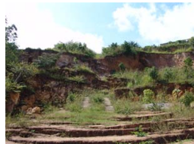
Figura 4. Esquisto y material residual dentro de la masa deslizada en Lomas de Tabure.
