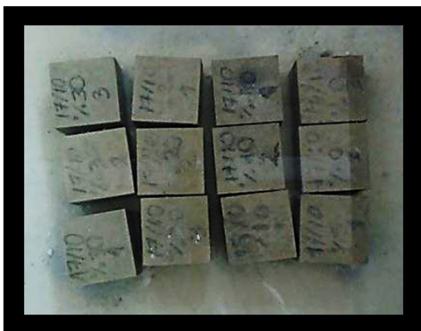
Figura 1. Probetas de morteros endurecidos retirados de la piscina de curado
