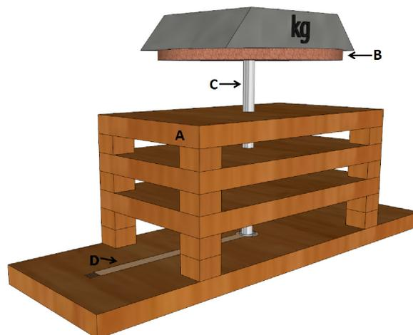
**Figura 3.** Esquema del montaje utilizado para someter los diseños de dispositivo a diferentes cargas entre 20 N y 460 N. Sobre una plataforma de latón (B), se pueden colocar pesas de diferente magnitud. Un vástago (C) de 9 mm de diámetro transmite la fuerza al prototipo de dispositivo colocado en la plataforma inferior. Una estructura de MDF (A) da estabilidad al vástago, sin afectar la transmisión de la carga al dispositivo
