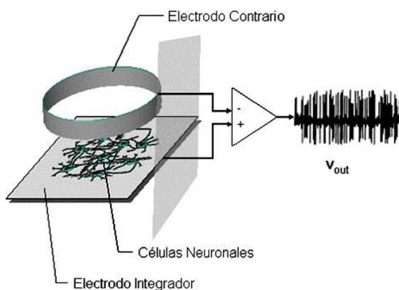
**Figura 4.** Diseño de pares electro – neuronales para adquisición – estimulación simple (Modificado de Silva, 2005)
