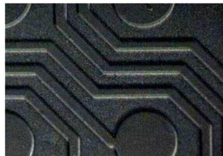
**Figura 3.** Superficie de “ITO” estructurada sobre sustrato de vidrio
