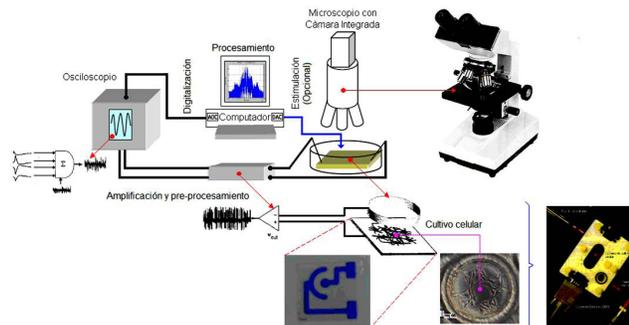
**Figura 7.** Sistema integrado que contempla módulos electrónicos para adquisición de las señales y comunicación con plataformas de procesamiento de la señal obtenida
