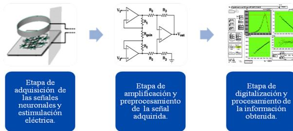
**Figura 2.** Esquema que presenta las etapas que definen la estructura del sistema modular que constituye a la interfaz bioelectrónica
