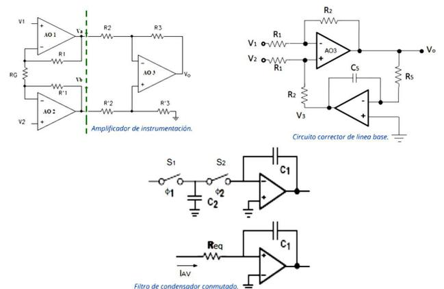
**Figura 5.** Circuito constituido por amplificador diferencial (basado en amplificador de instrumentación) con filtro de banda pasante
