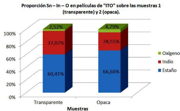
**Figura 9.** Diagrama de columnas representativo de la constitución del “ITO” en las muestras
