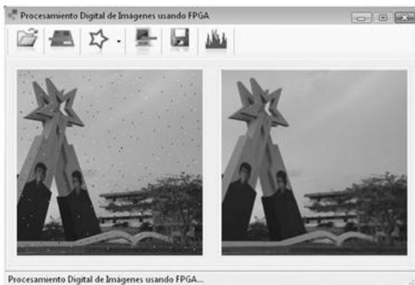
Figura 14. Reducción de ruido Sal y Pimienta mediante el filtrado de mediana
