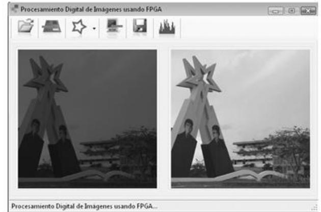
**Figura 12.** Mejoras de contraste mediante la expansión del histograma
