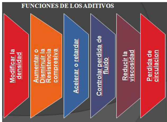
Figura 3. Funciones de los aditivos utilizados en cementación de pozos
