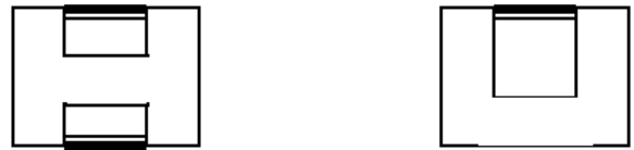
Figura 4. Solución con rigidizadores para plantas en forma de "H" y "U" (Fuente: Grases et al. 1987)
