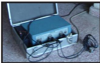
*Figura 14. Sismómetro Marslite y Sistema de adquisición de datos EDAS – 3M*
