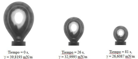
Figura 7. Secuencia de la burbuja de dióxido de carbono en agua a 3 MPa y 30 °C
