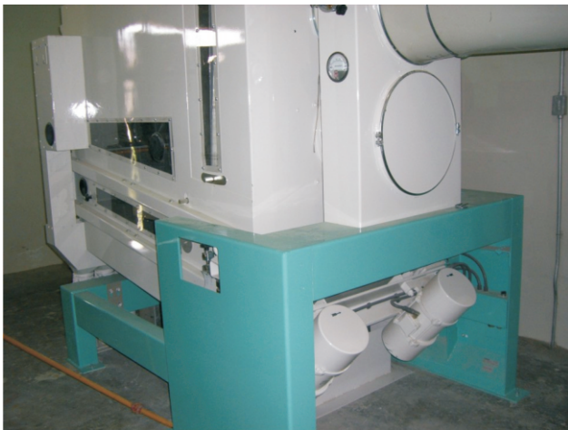
Figura 4. Deschinadora y sus rotores de excitación.
