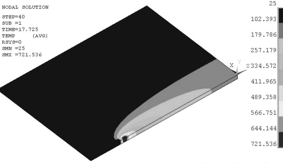
Figura 6. Campo de temperaturas para una tiempo  $t = 17,7$  s en modelo con malla intermedia.
