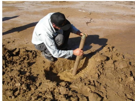
Figura 15. Toma de núcleo continuo corto de los bordes de la laguna de Los Patos, al Oeste de Cumaná, estado Sucre, para el estudio de paleo-tsunamis.
