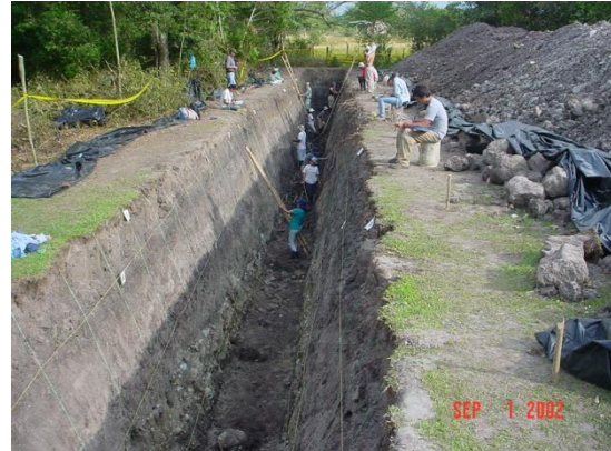
Figura 9. Vista general de la trinchera de Los Gomos (al este de Ibagué, departamento del Tolima), a través de la falla dextral de Ibagué. Se aprecia al grupo de participantes al Curso-Taller en Paleosismología, realizando el levantamiento de las paredes reticuladas (1 m x 1 m) de las paredes de la excavación. Aspecto típico de trinchera excavada por retro-excavadora (“jumbo”) de pala de 1 m de ancho.
