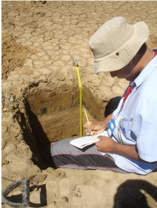
Figura 4. Levantamiento de columna estratigráfica de calicata de aproximadamente de 1 m x 1 m en planta, abierta para exponer secuencia de la laguna costera de Unare (estado Anzoátegui) con eventuales evidencias de incursiones marinas extraordinarias (paleo-tsunamis). El colega J. Oropeza realiza el levantamiento.
