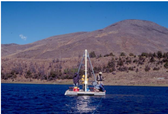
Figura 13. Toma de núcleos largos (segmentos del al menos 3 m de largo c/u) continuos del fondo de la laguna de Mucubají (estado Mérida), en proximidad a los segmentos Boc-b y Boc-c de la falla de Boconó.
