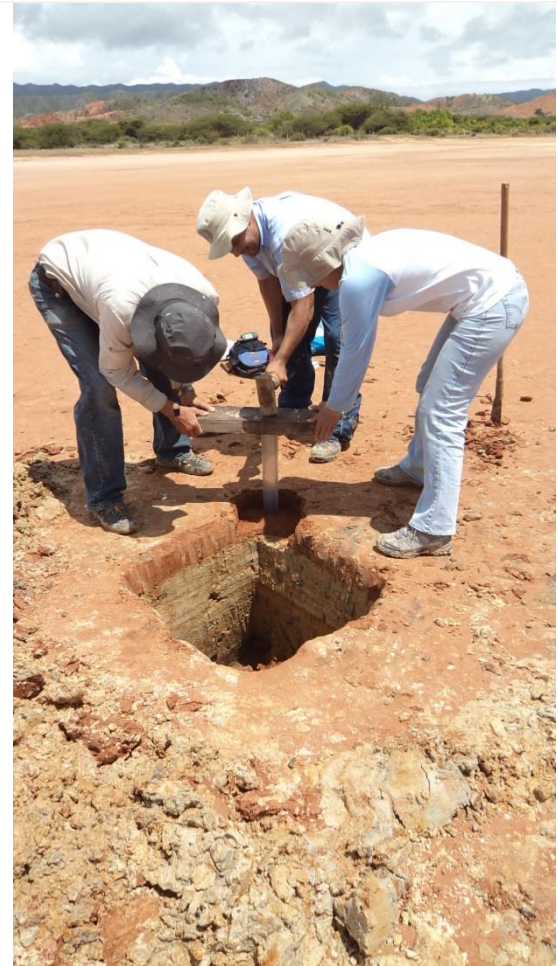
Figura 5. Extracción de núcleo corto en PVC, contiguo a pared de calicata abierta en la laguna costera de Chacopata (estado Sucre). Los colegas Beck y Vallée (†) sostienen madero grueso, mientras J. Oropeza hinca con mandarina el “liner” de PVC.
