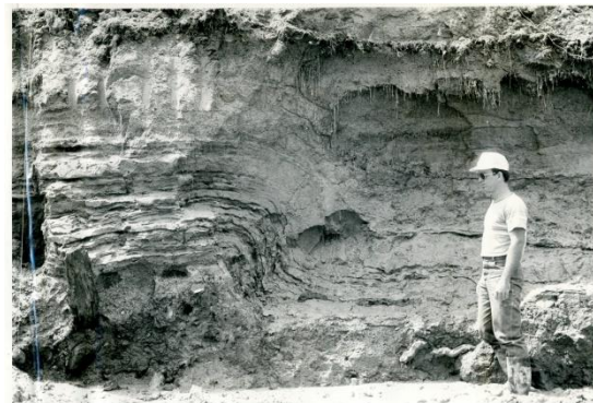
Figura 8. Vista de la pared sureste de la trinchera La Grita (próxima al Hotel La Montaña, estado Táchira), que expone un pliegue en propagación de falla en los sedimentos lacustres suprayacentes a depósito coluvial de ladera fallado frágilmente, con visible componente en falla normal, ubicado en posición central al pie de la pared. Nótese el tronco de árbol aún en posición de vida, hacia el extremo inferior izquierdo de la fotografía. El autor posa de escala, con los pies “sembrados” en lodazal (Foto cortesía del Dr. Jean-Pierre Soulas).
