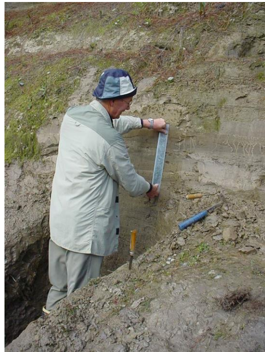
Figura 14. Toma de muestras continuas de afloramientos de la secuencia lacustre del paleo-lago Los Zerpa (morrena Los Zerpa, estado Mérida), por parte del Dr. Christian Beck, afectada por la falla de Boconó.
