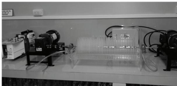
*Figura 1. Vista frontal del sistema experimental RBC empleado para evaluar el tratamiento aerobio de un efluente de procesamiento de pescado*
