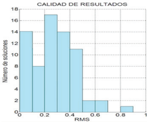
Figura 16. Distribución de los rms entre el conjunto de soluciones más probable y las funciones de transferencia calculada por el JSESAME para todos los puntos calculados
