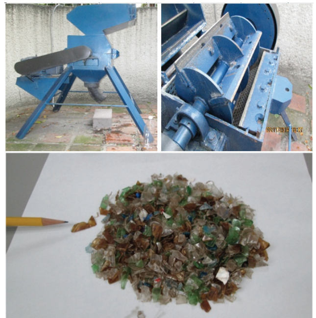
Figura 1. Máquina trituradora, hojuelas de PET
