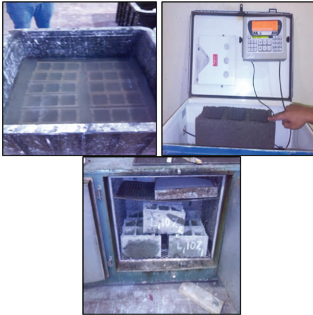
Figura 3. Bloques sometidos a ensayos de absorción de agua
