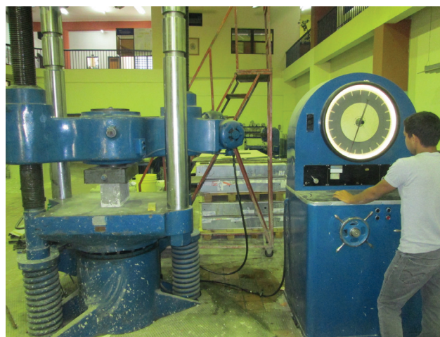
Figura 2. Bloque sometido a ensayo de compresión
