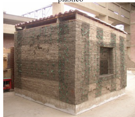
Figura 10. Daños en viviendas de adobe en Perú luego de ser sujetas a un sismo simulado en una mesa vibratoria (Blondet et al. 2006)
