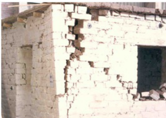
Figura 10. Daños en viviendas de adobe en Perú luego de ser sujetas a un sismo simulado en una mesa vibratoria (Blondet et al. 2006)
