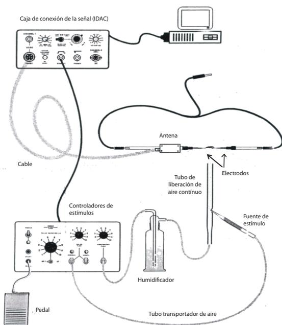
Figura 1. Esquema de un electroantenógrafo (Fuente: Syntech 1998).
