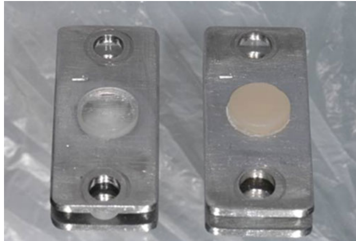
Fig.3 Apariencia de los especímenes de PMMA y de resina compuesta.
