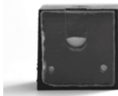
Figura 2- llenado de la matriz en capas incrementales de 2mm de resina con placa de vidrio adaptada
