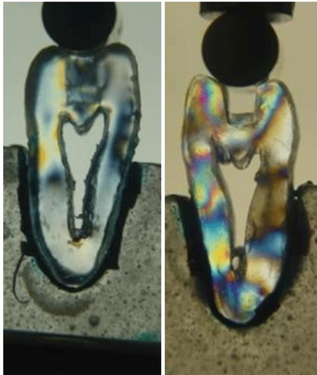
**Figura 5: modelo fotoelástico del diente con preparación cavitaria clase II D-O.**
