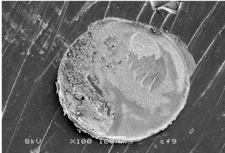
Figura 7 - Aspecto morfológico después del ensayo de microcizallamiento utilizando el Adper Single Bond. Se observa la falla mixta (Aumento de 100 x)
