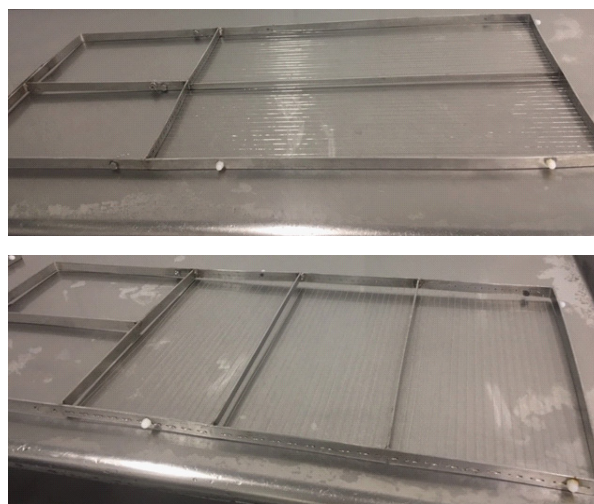
Figura 4. Liras de corte vertical (Foto superior) y horizontal. Cortesía Harvest Home Dairy LLC.
