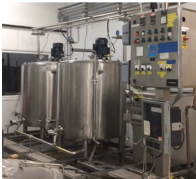
Figura 2. Pasteurizador Batch de doble tanque (1200 litros hora). Cortesía Harvest Home Dairy, LLC.
