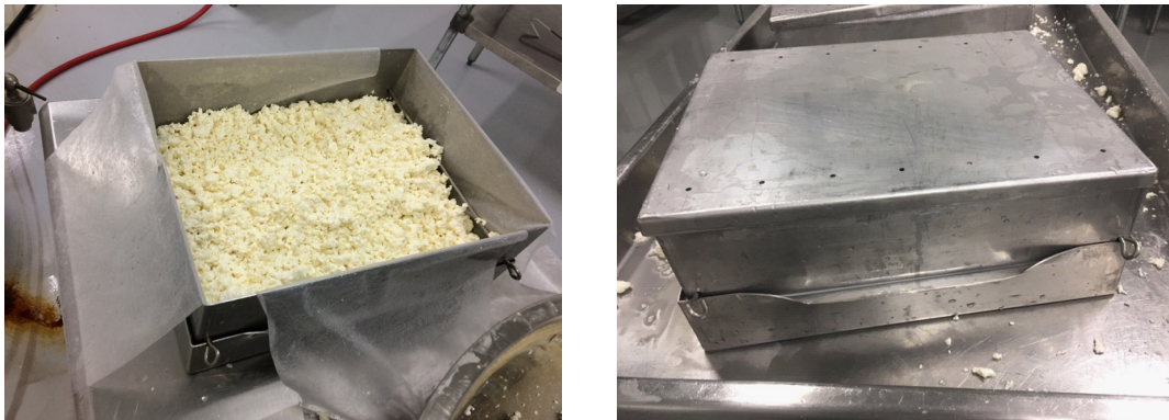
Figura 12. Moldes de acero inoxidable tipo Wilson de 20 libras de capacidad. Cortesía Harvest Home Dairy LLC.
