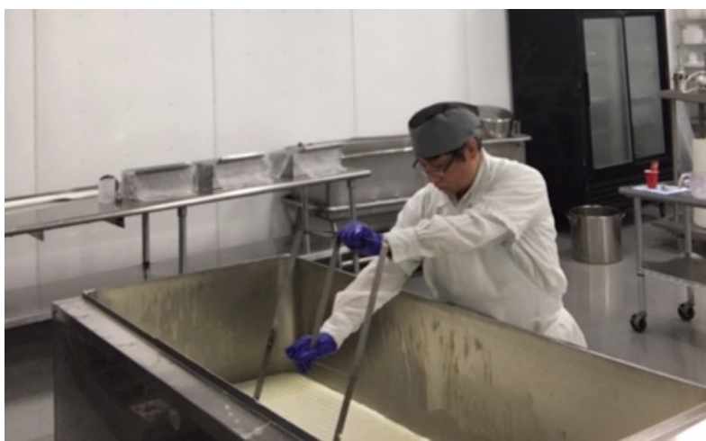
Figura 5. Autor de la obra realizando el corte con lira horizontal del queso Gouda. Cortesía Harvest Home Dairy LLC.
