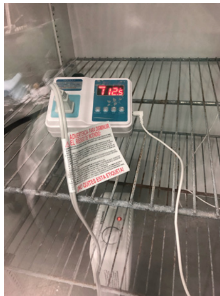
Figura 9. Control de la temperatura con termostato y calentador portátil en cámara de incubación. Foto cortesía de Harvest Home Dairy LLC.
