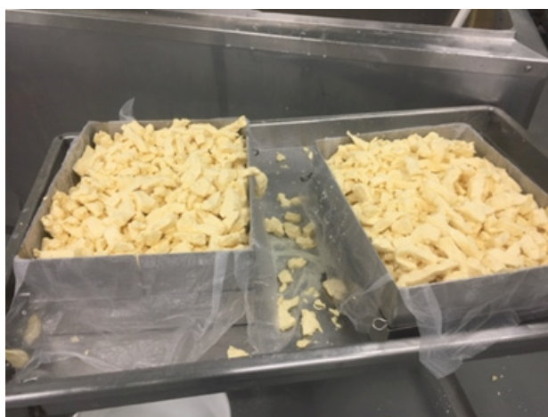
Figura 7. Moldeado en moldes Wilson. Capacidad 10 kg de cuajada. Cortesía de Harvest Home Dairy, LLC.
