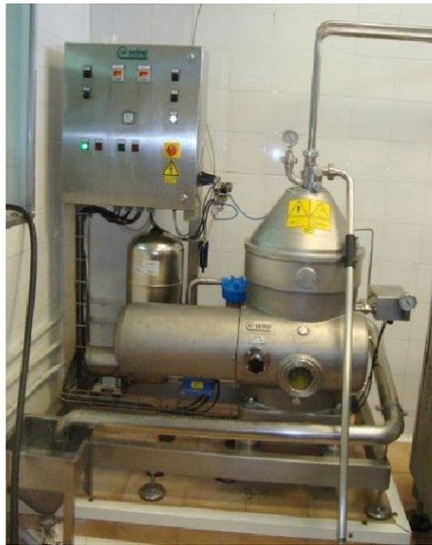
**Figura 2.** Centrifuga empleada tanto para las operaciones de clarificación y descremado Cortesía IMPROLAC (2019).
