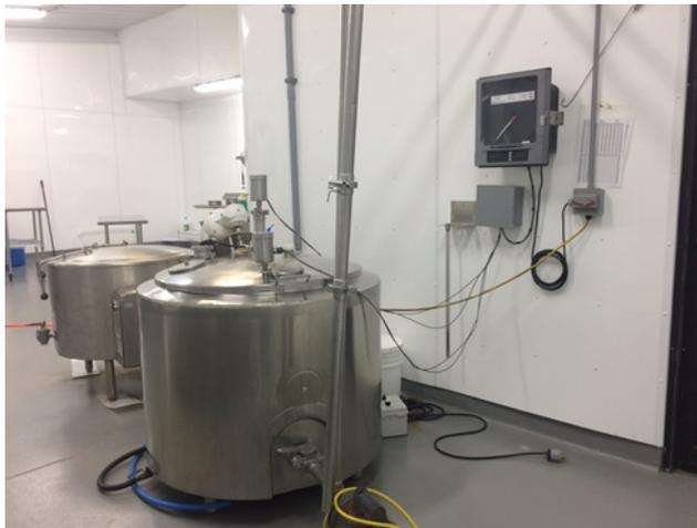
**Figura 5.** Tanque pasteurizador para sistema LTLT. Cortesía Harvest Home Dairy, LLC.
