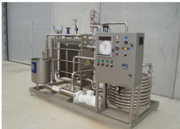
**Figura 7.** Sistema de Pasteurización continuo HTST. Cortesía de IMPROLAC, (2019).
