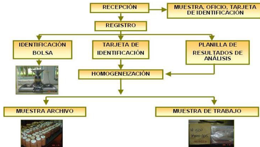
Figura 2. Flujograma de recepción, registro y homogenización de las muestras de semillas.
