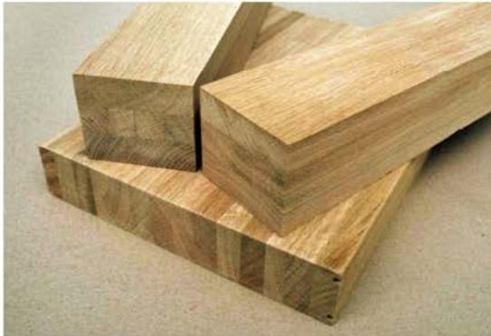
Figura 2. Elementos de madera laminada encolada.
