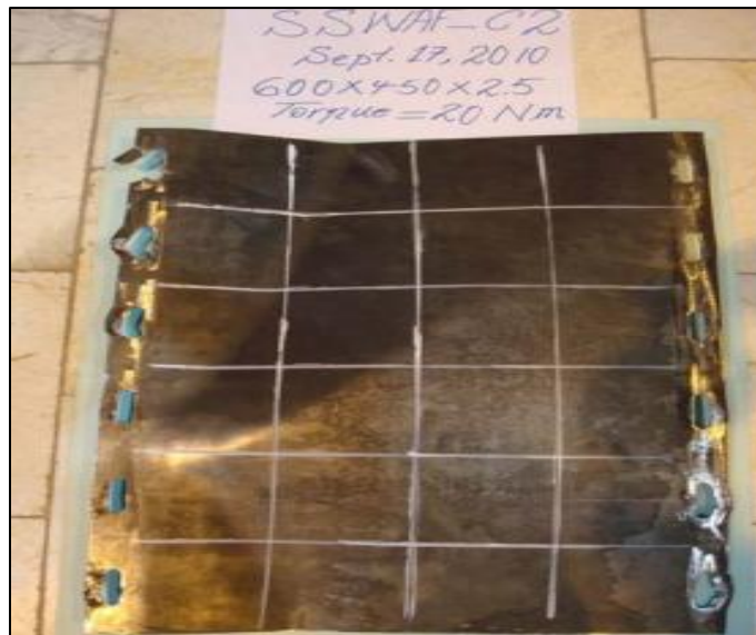
Fig. 35. Placas utilizadas en el segundo ensayo cíclico con las deformaciones graves y el desgarramiento Fuente: S.V. Khonsari, H. Seyf, S. Mehryar & M. Shahsavari-Gargari Sharif .Experimental Study of a New Steel Shear Wall with an Embedded Special Damping Mechanism (SSWAF) (2012)
