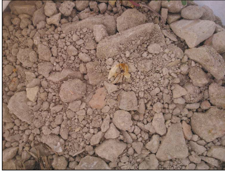
Figura 4: Aspecto original del R.C.D.
