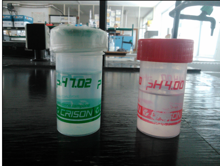
Figura 30: Disoluciones Tampón comerciales usadas en la fase de calibración
