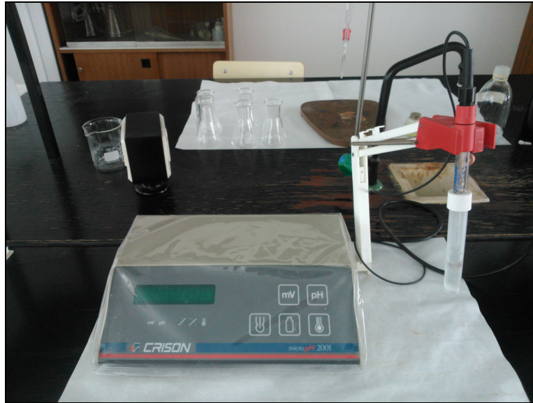
Figura 29: pH-metro con el correspondiente electrodo
