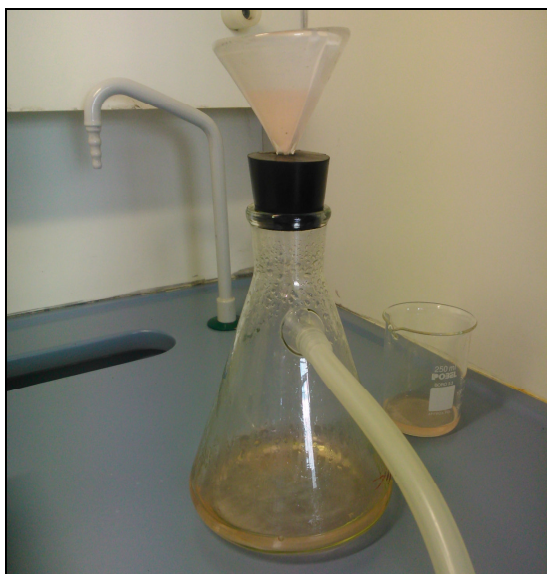
Figura 39: Matraz con embudo y conectado a bomba de vacío
