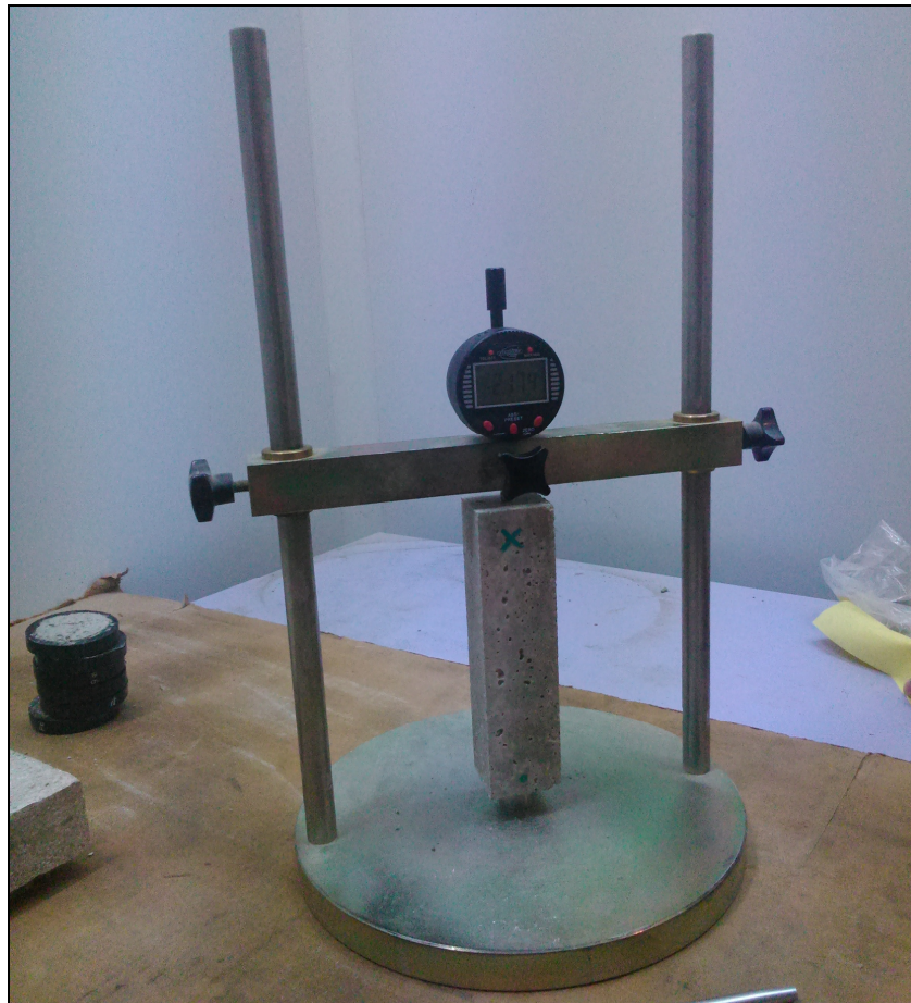
Figura 46: Probeta sometida a la lectura de la longitud
