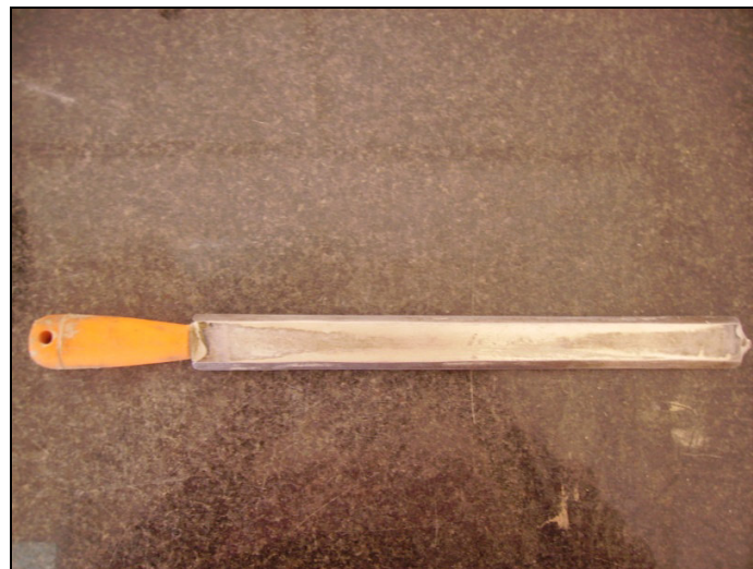
Figura 22: Enrasador utilizado en el ensayo de consistencia
