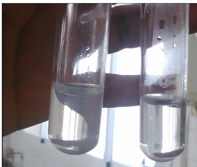
Figura 41: Contraste entre dos muestras, la de la izquierda tiene un tono blanquecino, indicador de presencia de cloruros
