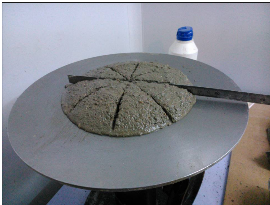
Figura 26: Medición de la consistencia del mortero
