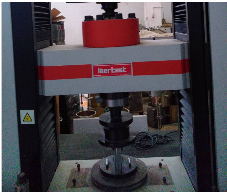
Figura 44: Máquina de ensayo de resistencia a flexión y compresión
