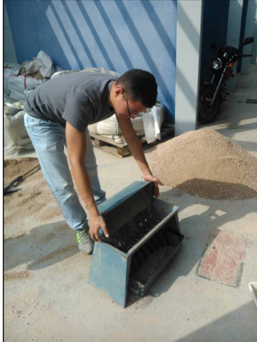
Figura 3: Operación de cuarteo
