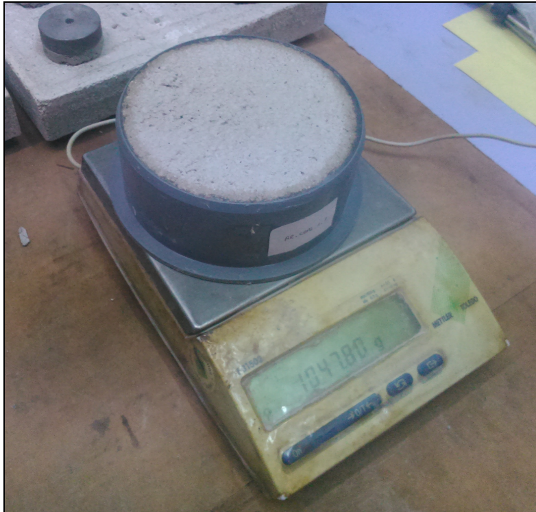
Figura 48: Peso de una de las probetas dentro del recipiente
