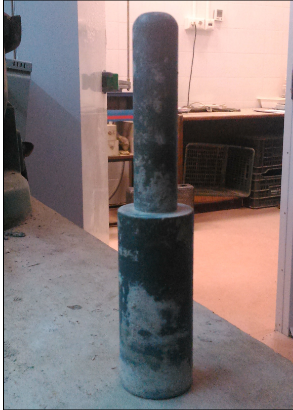
Figura 20: Pisón utilizado en la prueba de consistencia
