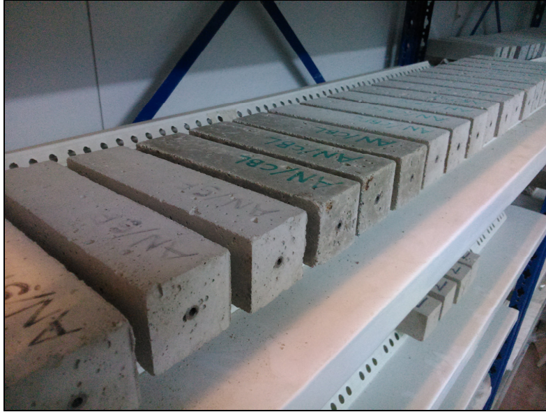
Figura 45: Probetas en cámara para el ensayo de retracción
