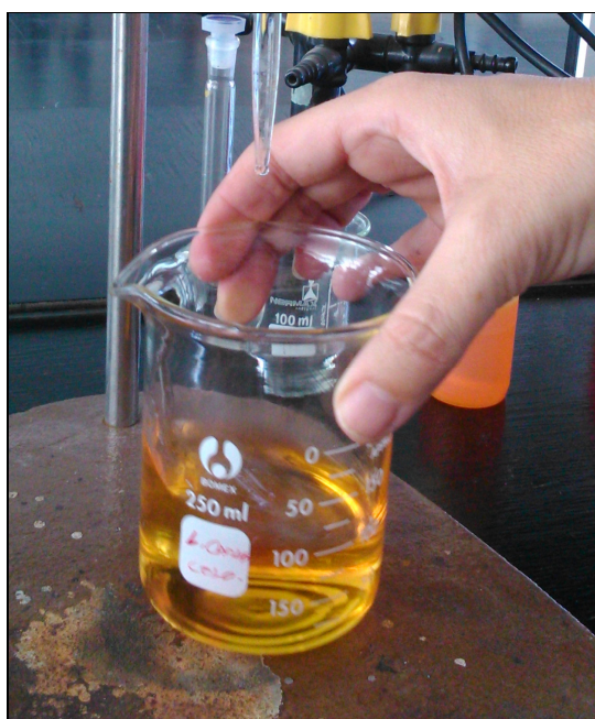
Figura 37: Aspecto de la muestra de agua tras la primera adición de gotas de naranja de metilo
