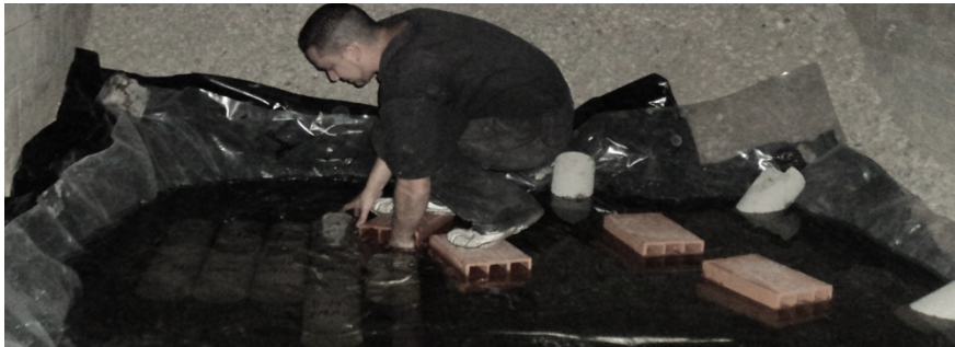
Proceso de Curado de los Cilindros en la Piscina con Adición del Cal
