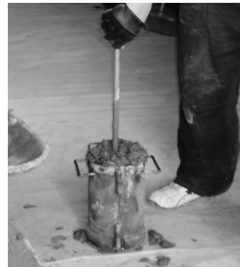
Anexo 5: Proceso de Compactación a cilindros estandarizados de concreto
