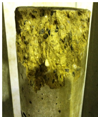
Anexo 16: falla del cilindro 1 de la mezcla CC28
