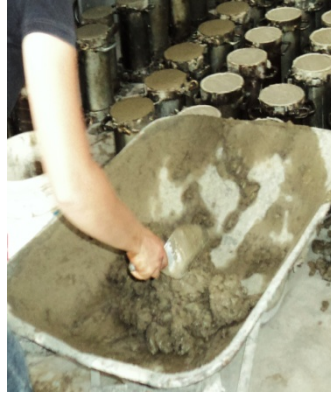
Mezclado de Concreto Fresco
