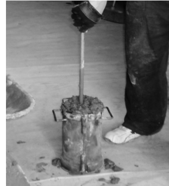
Proceso de Compactación a cilindros estandarizados de concreto
