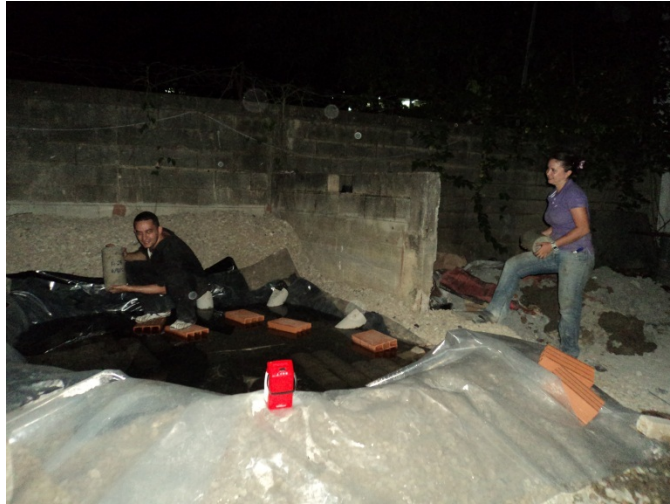
Anexo 6: Proceso de Curado de los Cilindros en la Piscina con Adición del Cal
