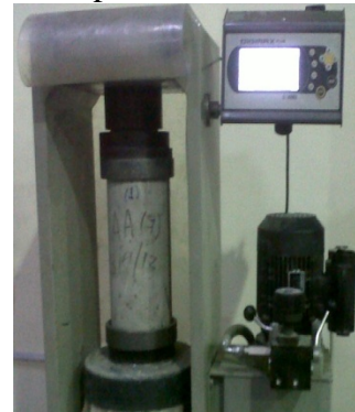
Anexo 10: Ensayo de Compresión Pura a las probetas estandarizadas
