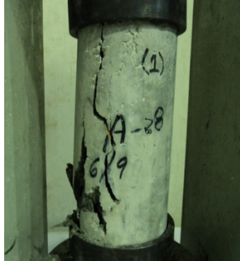
Anexo 11: falla del cilindro 1 de la mezcla A28
