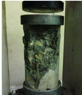
Anexo 12: falla del cilindro 1 de la mezcla AA14
