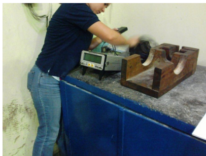
Anexo 8: Medición del Pulso Ultrasónico en los cilindros
