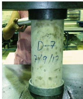
Medición de Esclerometría a cilindros estandarizados de concreto
