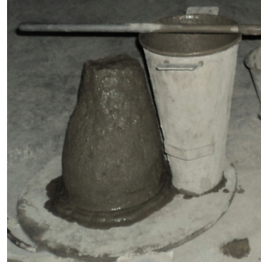
Anexo 4: Medición del Asentamiento mediante el Cono de Abrams en el Concreto
