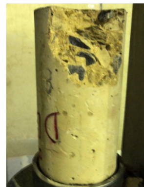
Anexo 18: falla del cilindro 1 de la mezcla DD14
