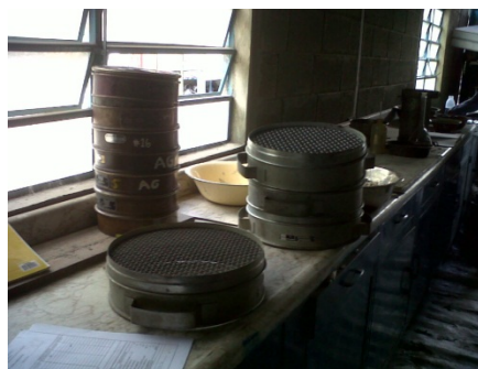
Tamizado de los agregados gruesos
