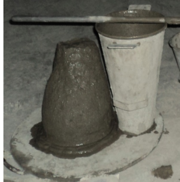
Medición del Asentamiento mediante el Cono de Abrams en el Concreto
