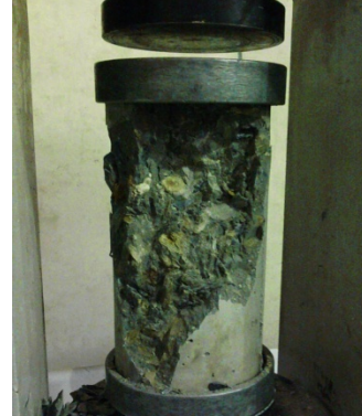
Anexo 13: falla del cilindro 1 de la mezcla B14
