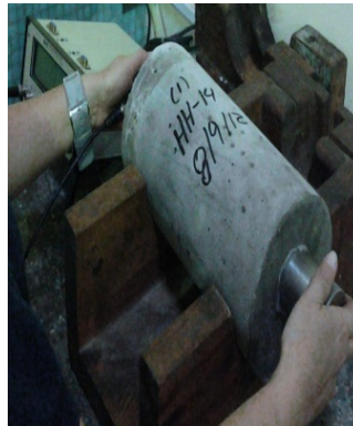
Medición del Pulso Ultrasonico en los cilindros
