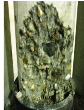
Anexo 14: falla del cilindro 1 de la mezcla BB28
