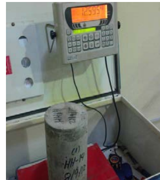
Anexo 9: Pesaje de los Cilindros de Concreto
