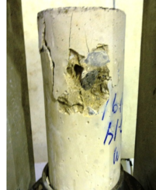
Anexo 17: falla del cilindro 1 de la mezcla D14
