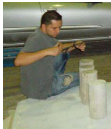
Medición de diámetro y altura de los Cilindros de Concreto
