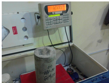
Pesaje de los Cilindros de Concreto
