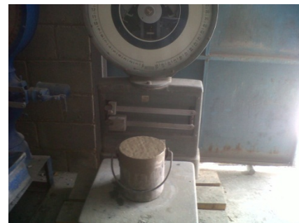
Pesaje de la tara normalizada más la mezcla de concreto fresco
