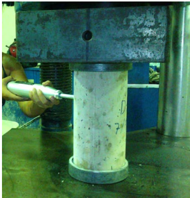
Anexo 7: Medición de Esclerometría a cilindros estandarizados de concreto
