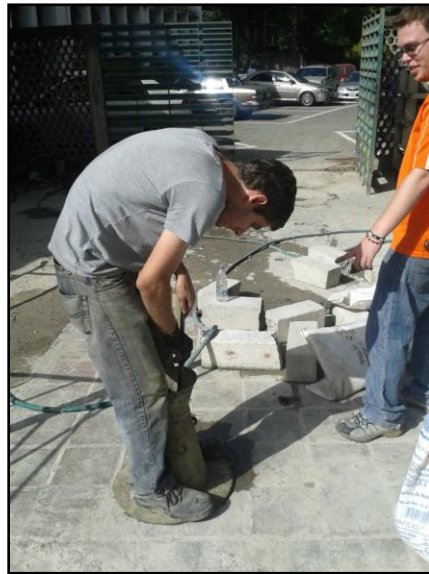
Figura 18. Elaboración del Cono de Abrams.
