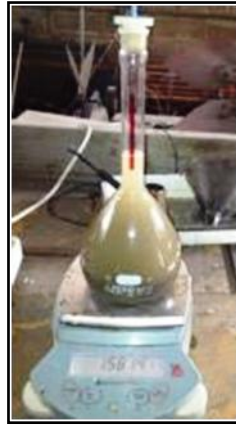
Figura 7. Picnómetro con la muestra y el agua
