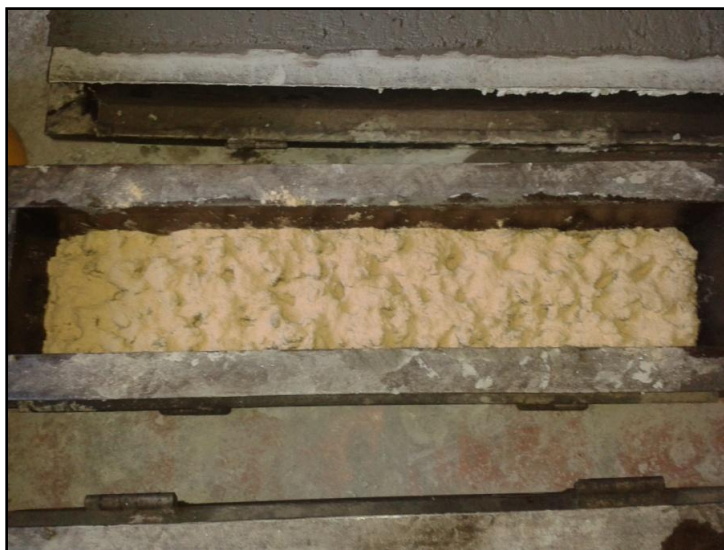
Figura 17. Vaciado de viga con junta en su capa central.
