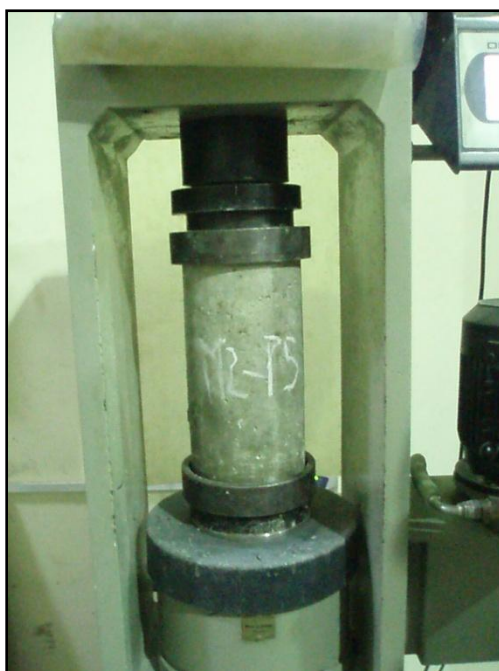
Figura 19. Ensayo a compresión de cilindros de concreto.
