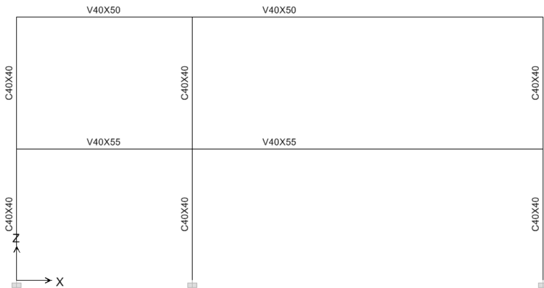
Figura 4.10 Dimensiones de los elementos del pórtico 2.
