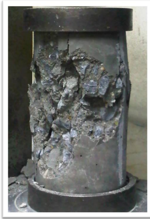
Figura 7 “Mezcla gruesa sin aditivo ensayada a compresión a los 28 días”
