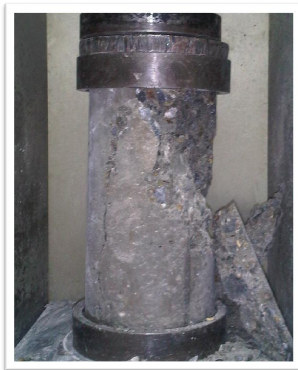
Figura 12 “Mezcla Fina con aditivo ensayada a compresión a los 28 días”
