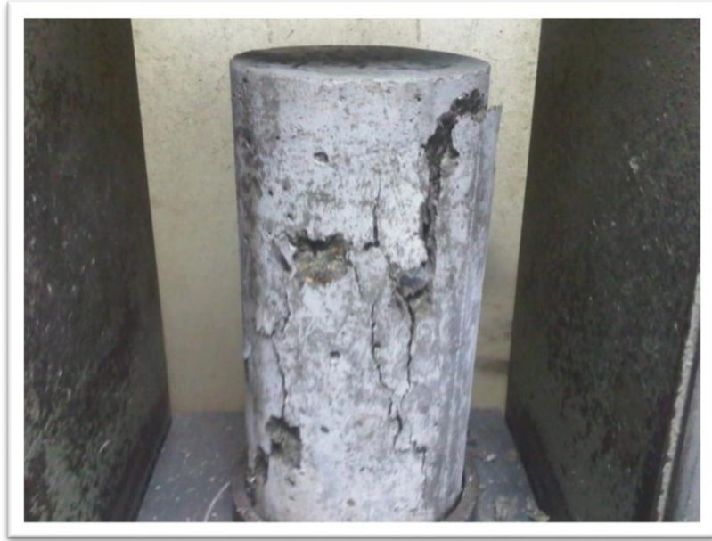
Figura 4 “Ensayo de compresión simple. Edad: 7 días”
