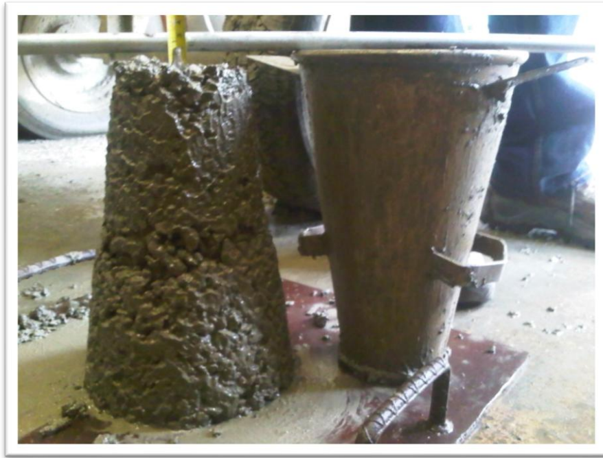
Figura 5 “Ensayo de Cono de Abrams: Mezcla patrón FNC”
