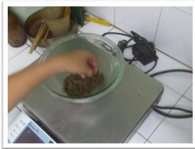
Figura 1 “Ensayo contenido de humedad del agregado fino”
