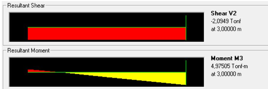
**Figura IV. 30. Diagramas de corte, momento y deformaciones para la columna 2-A del Nivel 1, en la ETAPA 2.**
