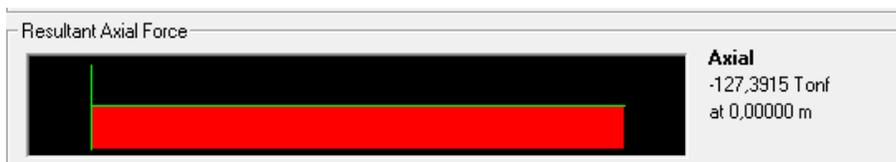
**Figura IV. 25. Carga axial para la columna 2-A del Nivel 1, en la ETAPA 20.**
