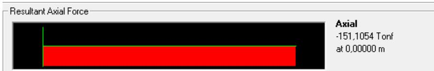
**Figura IV. 27. Carga axial para la columna 2-A del Nivel 1, en la ETAPA 24.**
