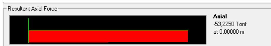
**Figura IV. 19. Carga axial para la columna 2-A del Nivel 1, en la ETAPA 8.**
