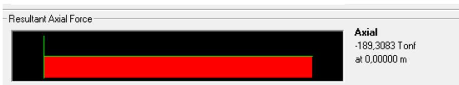
**Figura IV. 29. Carga axial para la columna 2-A del Nivel 1, en la ETAPA 25.**
