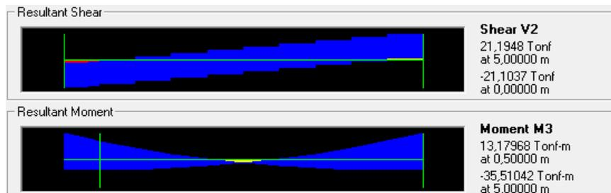
**Figura IV. 52. Diagramas de corte y momento para la viga del Nivel 1, Pórtico 2, Tramo C-D, en la ETAPA 16.**
