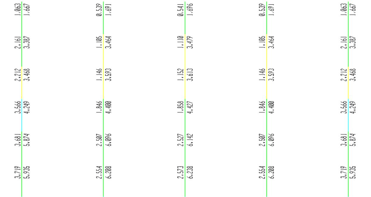
**Figura III. 22. Relación columna fuerte - viga débil (PISO7 a PISO12).**
