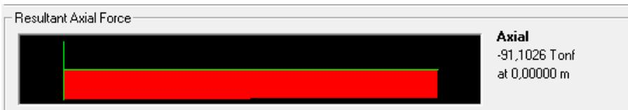
**Figura IV. 22. Carga axial para la columna 2-A del Nivel 1, en la ETAPA 14.**
