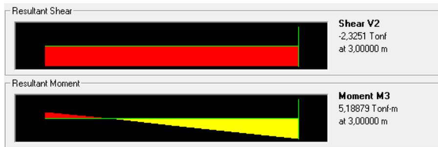
**Figura IV. 41. Diagramas de corte, momento y deformaciones para la columna 2-A del Nivel 1, en la ETAPA 24.**
