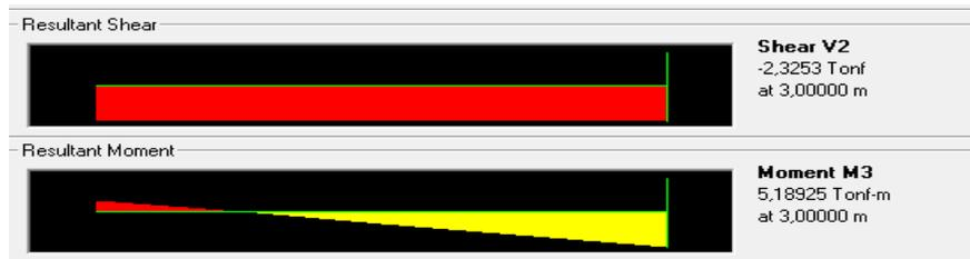
Figura IV. 42. Diagramas de corte, momento y deformaciones para la columna 2-A del Nivel 1, en la ETAPA 25 (F' C 28 DIAS).
