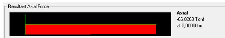
**Figura IV. 20. Carga axial para la columna 2-A del Nivel 1, en la ETAPA 10.**
