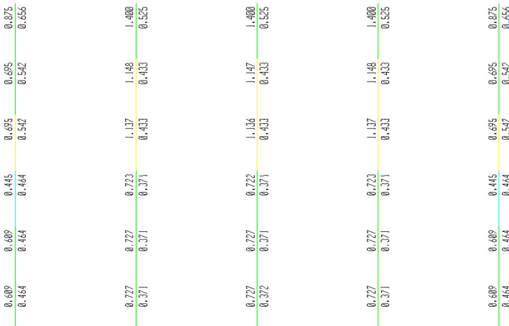
Figura III. 26. Relación demanda/capacidad por corte en nodos (PISO7 a PISO12).
