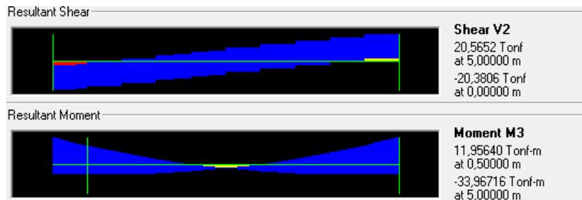
**Figura IV. 55. Diagramas de corte y momento para la viga del Nivel 1, Pórtico 2, Tramo C-D, en la ETAPA 22.**
