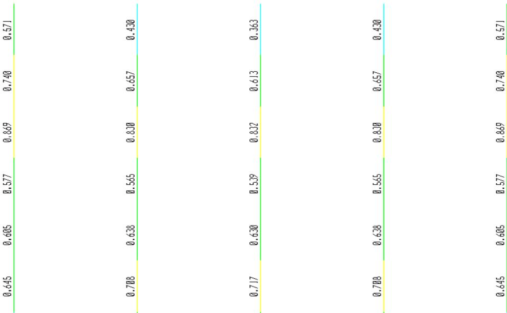
**Figura III. 20. Relación demanda/capacidad de las columnas del pórtico 2 (PISO7 a PISO12).**
