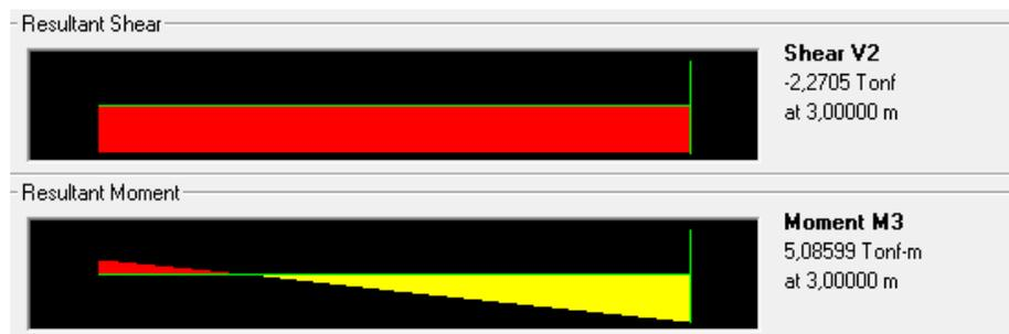
**Figura IV. 38. Diagramas de corte, momento y deformaciones para la columna 2-A del Nivel 1, en la ETAPA 18.**
