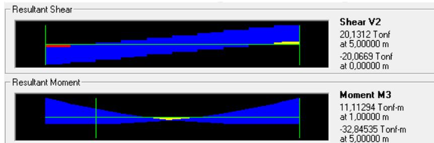
**Figura IV. 51. Diagramas de corte y momento para la viga del Nivel 1, Pórtico 2, Tramo C-D, en la ETAPA 14.**
