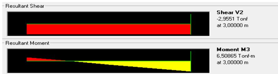
Figura IV. 43. Diagramas de corte, momento y deformaciones para la columna 2-A del Nivel 1, en la ETAPA 25 (F' C 28 DIAS CON SCP).
