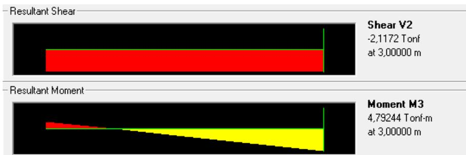
**Figura IV. 32. Diagramas de corte, momento y deformaciones para la columna 2-A del Nivel 1, en la ETAPA 6.**
