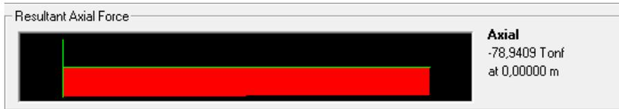
**Figura IV. 21. Carga axial para la columna 2-A del Nivel 1, en la ETAPA 12.**
