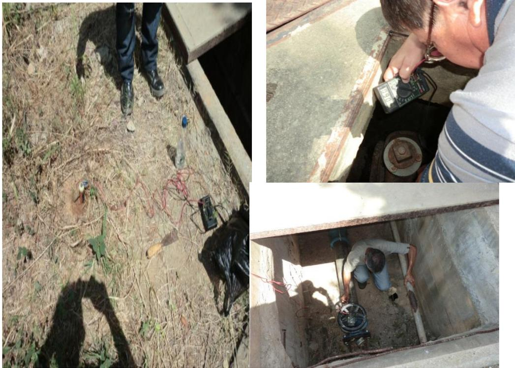
**Figura 17. Lecturas de Potenciales tomadas en las dos Tanquillas.**
