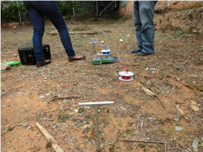
**Figura 14. Mediciones por el Método de Wenner o de los cuatro pines.**
