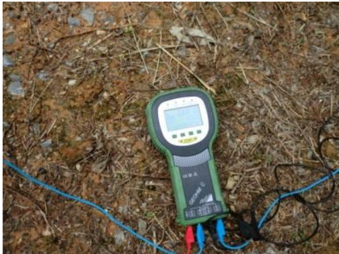
**Figura 16. Aparato GEOHM C utilizado en las mediciones.**
